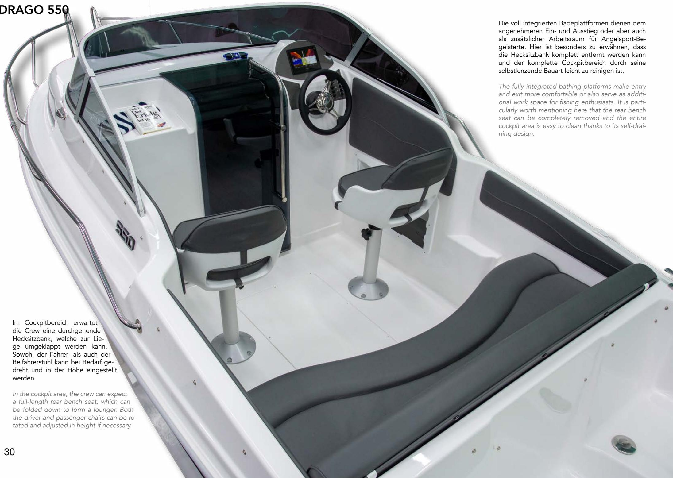
Im Cockpitbereich erwartet die Crew eine durchgehende Hecksitzbank, welche zur Liege umgeklappt werden kann. Sowohl der Fahrer- als auch der Beifahrerstuhl kann bei Bedarf gedreht und in der Höhe eingestellt werden.
